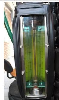
**Tabla A15. Flujómetro para agua de enfriamiento del CO**
