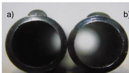
**Figura 4.6** Humectabilidad de la helicoidal a) Textura Sandblast y b) Textura lisa
