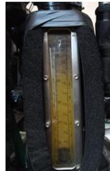
**Tabla A14. Flujómetros del agua de calentamiento**
