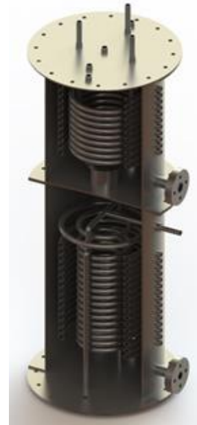
Fig.2. 2 Disposición de los intercambiadores GE-CO [Delgado- Gonzaga, 2018].
