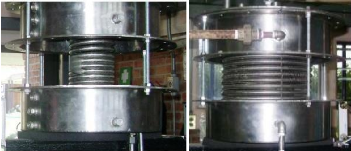
Fig.2. 7 Evaporador (izquierda) y Absorbedor (derecha).
