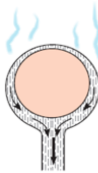
Fig.2. 4 Representación de la película descendente y el vapor generado.
