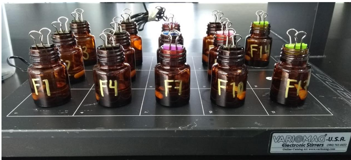
Figura 13. Montaje del sistema para determinar la eficiencia de encapsulación mediante bolsas de diálisis
