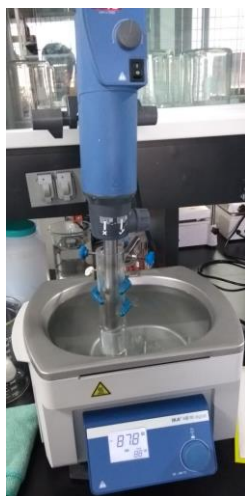
Figura 11. Sistema Ultraturax con baño utilizado para obtener los NLCs
