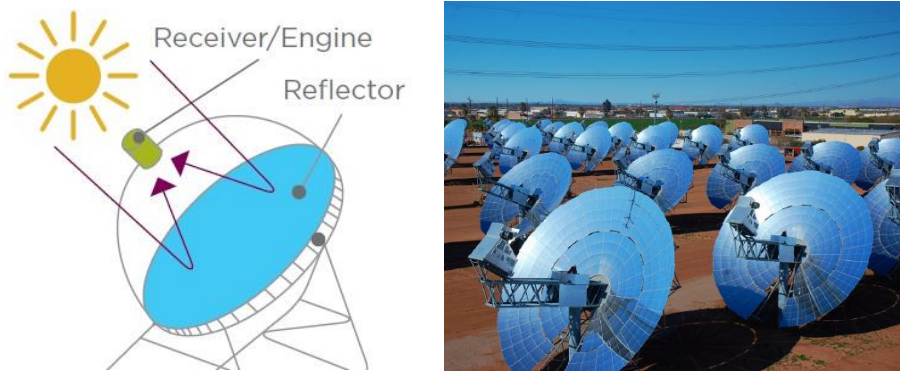
Figura 16. Sistema de concentración solar de disco parabólico [37].
