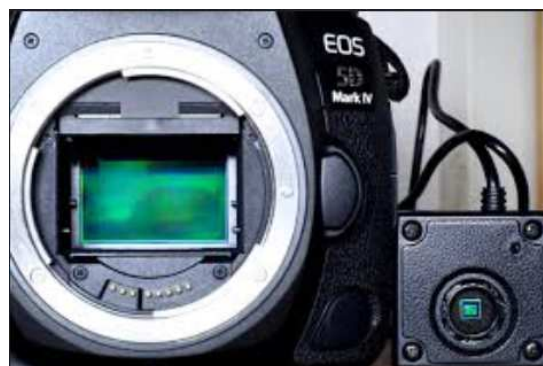
Figura 8. Sensor de una cámara fotográfica.
