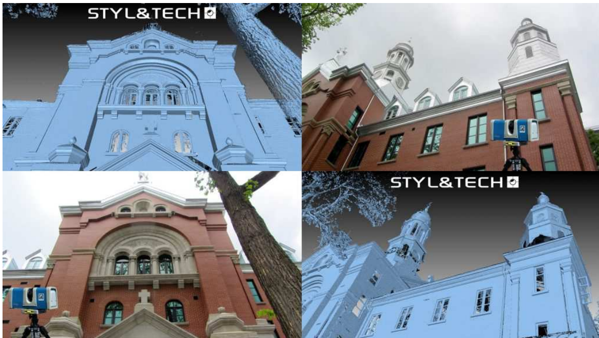
Figura 41 Reconstrucción 3d de edificios.
