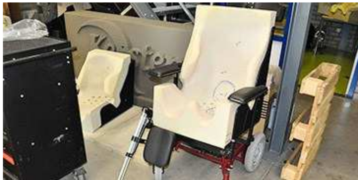
Figura 36 Ingeniería inversa para la fabricación de sillas de ruedas a medida.
