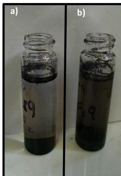
Figura 4.34 Fotografías de la muestra Fs9 a) material lavado de las paredes del matraz b) material lavado después del tratamiento con 270 flash.
