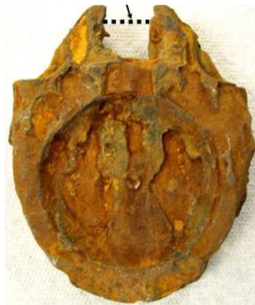
Figura 3. Corrosión general. Tomada de Tait 2018.
