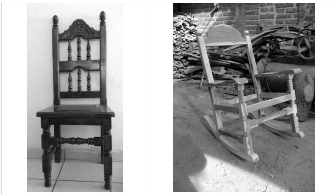
Fotografía 77. Taller del señor Yepes, Guasave, Sinaloa. Mobiliario elaborado o en reparación. a) Silla con talla y elementos torneados, b) Armazón de poltrona de amapa al natural.
