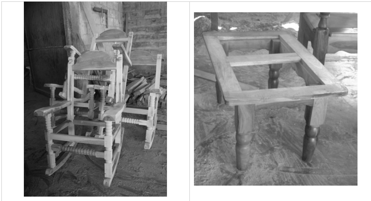
Fotografía 72. Mobiliario en la Cooperativa de Buchinari, Sinaloa. a) armazones de poltronas, este es el color natural de la amapa, y b) Mesa para sala para colocar dos vidrios en el centro; amapa barnizada.
