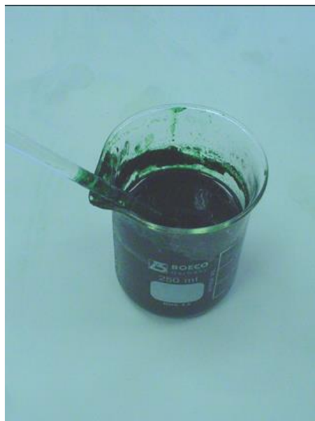
Figura 4.18 Fotografía del producto de síntesis de la polimerización de la PANI, en el cual se obtiene el producto de color verde, característico de la sal de emeraldina (forma conductora de la polianilina).
