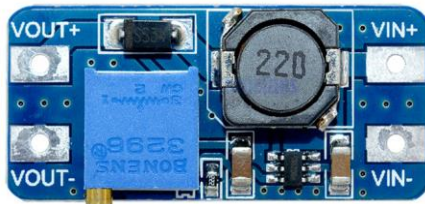
Figura 2.13 Convertidor o regulador conmutado Step Up (elevador, boost converter) CC-CC (MT3608)
