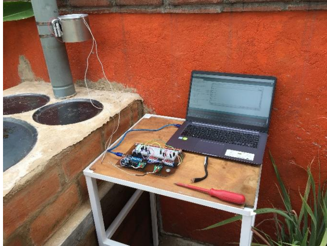
Figura 3.17 Mediciones de temperaturas tanto en los display del dispositivo como en la computadora por medio de las herramientas de Arduino
