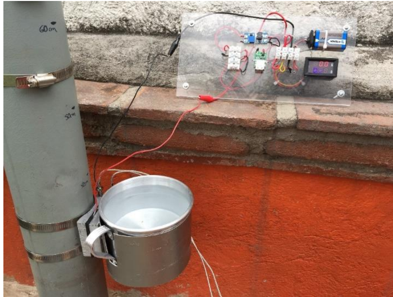
Figura 3.11 Dispositivo TEG acoplado en el tubo de escape
