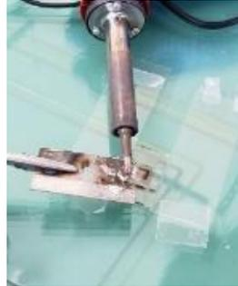
Figura 8: Sellado de orificios de la CSSC.
