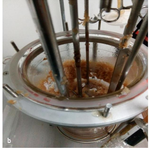
Imágenes correspondientes al biorreactor tanque agitado con el cultivo de la cepa G-397 del hongo *Ganoderma curtisii*. a) Biorreactor a 30°C, donde se observa una gran cantidad de biomasa al final de la cinética. b) Biorreactor a 25°C, igual forma corresponde al final de la cinética, salvo que en este caso la biomasa no rodeo la superficie del biorreactor.
