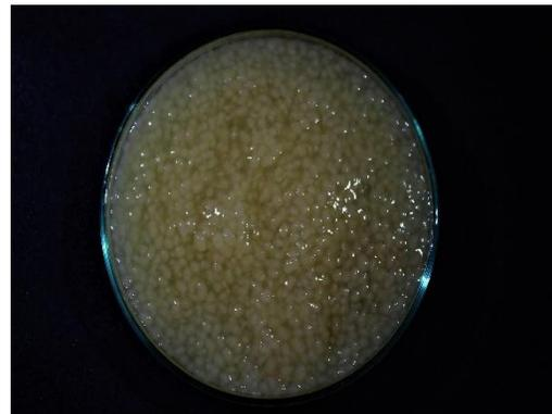
Pellets más homogéneos de la biomasa obtenidos de biorreactor tipo tanque. La imagen corresponde al biorreactor a 30°C de la cepa G-397 del hongo *Ganoderma curtisii*.
