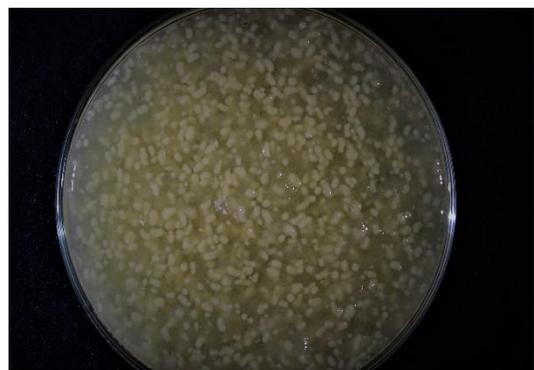
Pellets de biomasa obtenidos de biorreactor tipo tanque. La imagen corresponde al biorreactor a 25°C de la cepa G-397 del hongo *Ganoderma curtisii*.
