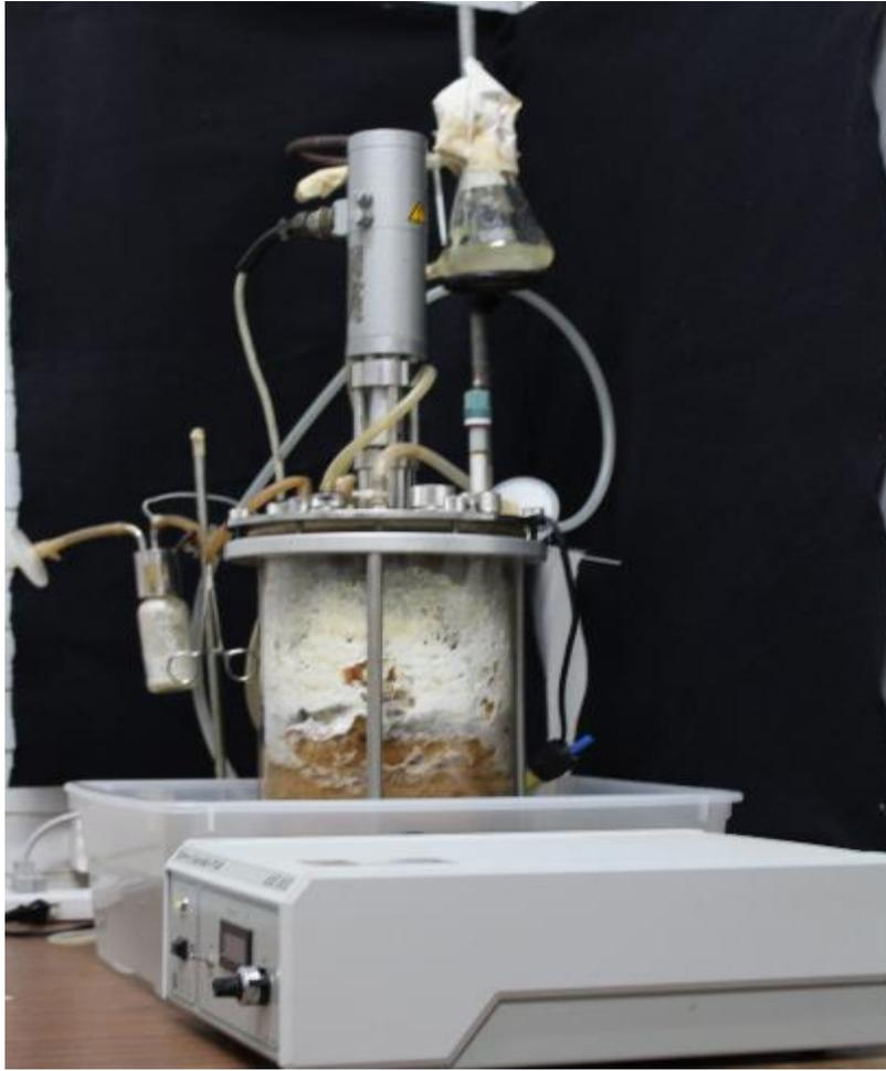
Biorreactor tipo tanque agitado de 7L por medio del cual se desarrollaron las cinéticas de crecimiento para evaluar su producción de biomasa y polisacáridos extracelulares. La imagen corresponde al biorreactor a 30°C de la cepa G-397 del hongo *Ganoderma curtisii*.
