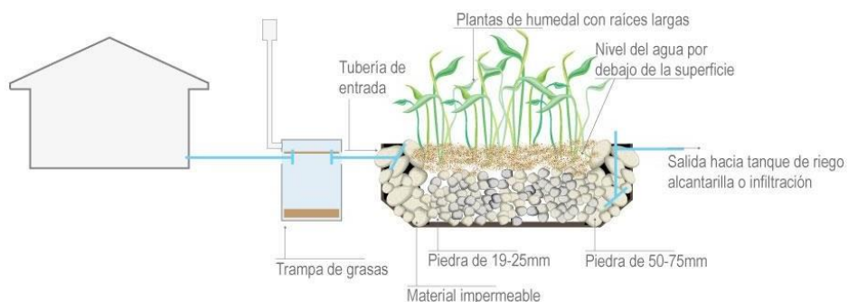
Figura 4. Biojardinería: Sistema de reciclaje de aguas grises. Fuente: Tomada de Rosales, 2005.
