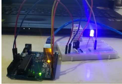
Figura 2.4 Prendiendo un Led conectado a la placa Arduino Uno, cuando se registra cierta temperatura
