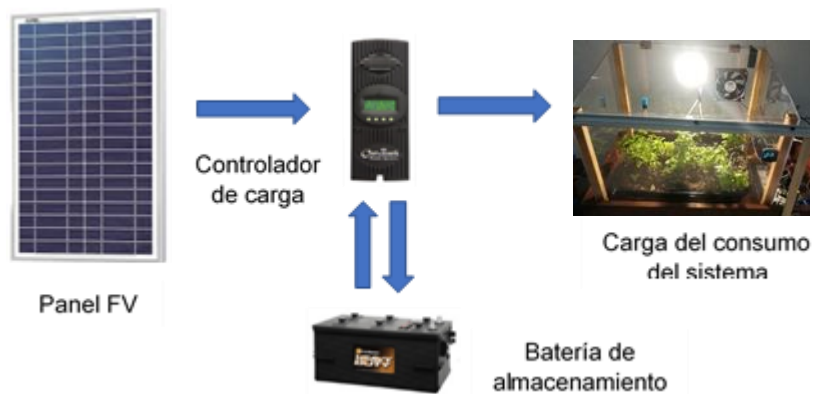
Figura 3.19 Diseño de Sistema Fotovoltaico de corriente directa con baterías de almacenamiento para suministrar energía a lámpara led de prototipo invernadero
