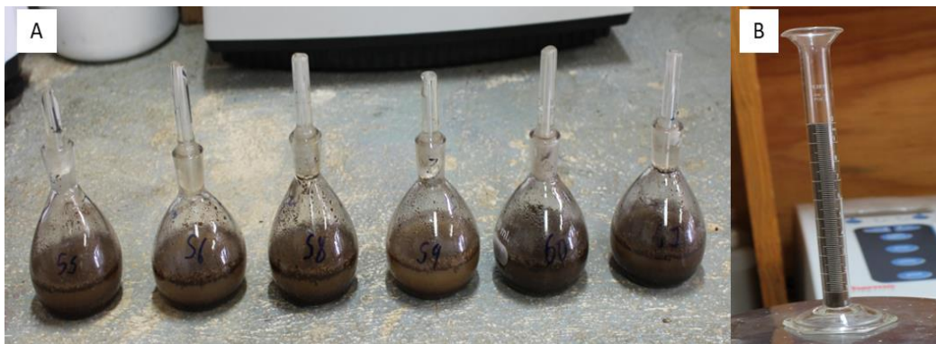
Figura 8. Densidad real y aparente. A. Proceso para densidad real, suelo más agua reposando en los picnómetros por 30 minutos antes de llenar con agua destilada. B. Determinación de la densidad aparente, llenado de la probeta de 10 ml con suelo para ser pesado.
