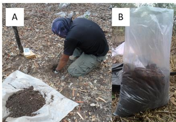
Figura 7. Extracción de muestra de suelo. A. Obtención de muestra de suelo compuesta de 5 a 20 cm de profundidad de la zona 2 caliza. B. Transporte de 2 kg de muestra en bolsas para posteriormente ponerlas a secar.
