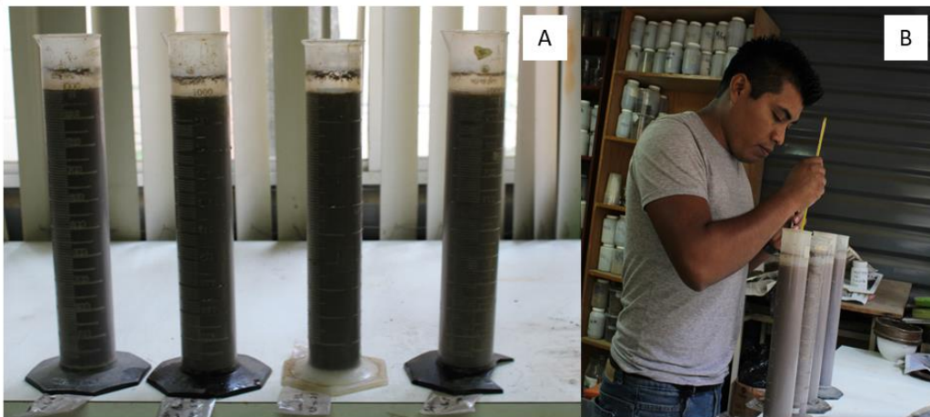
Figura 9. Determinación de texturas. A. Reposo de las muestras una vez obtenida la primera lectura. B. Obtención de la segunda lectura dos horas después de reposar.
