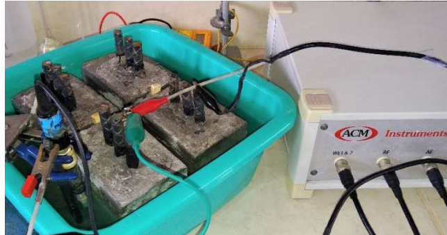
Figura 3. 17. Esquema de la celda para la técnica de espectroscopía de impedancia electroquímica.
