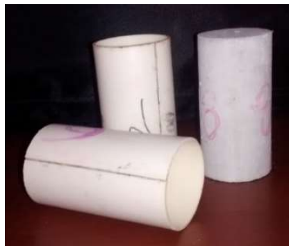
Figura 3. 10. Probetas para el ensayo de resistencia a la compresión.
