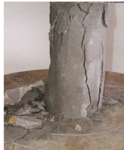
Figura 4. 11. Tipo de fallo de la muestra control.
