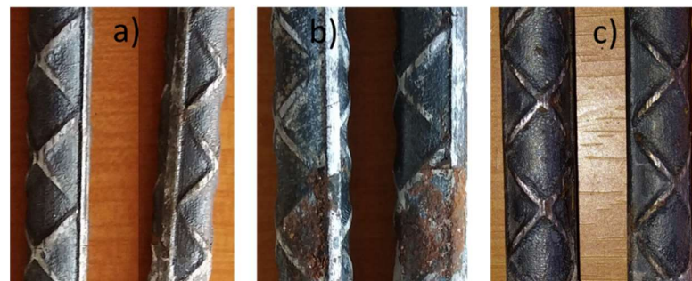
Figura 4. 47. Varillas de acero extraídas del concreto posterior a los 300 días de exposición al medio agresivo, para las muestras con fibras cortas de PET; a) CO+3%FC, b) CO+5%FC y c) CO+8%FC.
