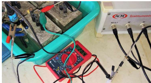
Figura 3. 18. Aplicación de la Resistencia a la Polarización Lineal.
