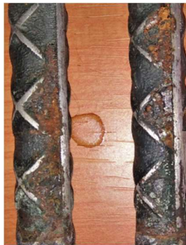
Figura 4. 43. Varillas de acero de la muestra control, extraídas del concreto posterior a los 300 días de exposición al medio agresivo.
