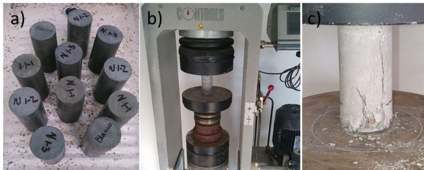
Figura 3. 14. a) Probetas a los 28 días de curado, b) Ensayo de compresión y c) Fallo de la probeta después de realizada la prueba.
