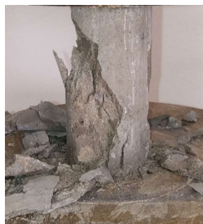
Figura 4. 6. Tipo de fallo de muestra control.
