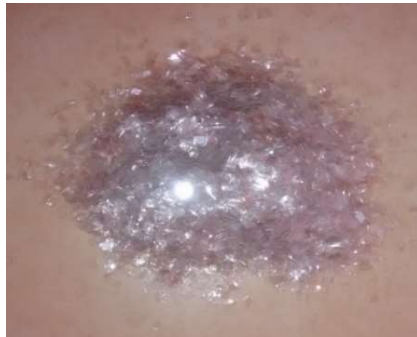
Figura 3. 4. PET, partículas rectangulares.
