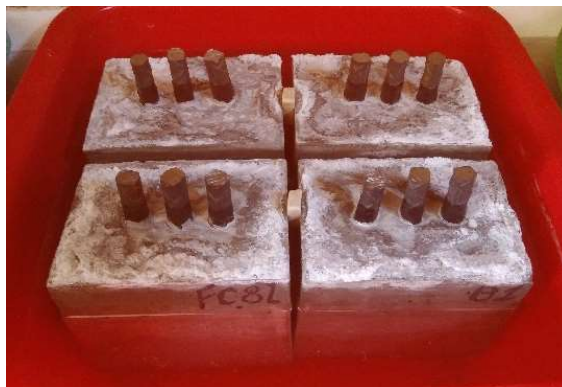
Figura 3. 13. a) Probetas parcialmente sumergidas en una solución de cloruro de sodio al 3%.
