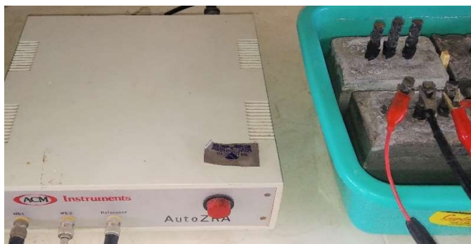
Figura 3. 16. Medición de ruido electroquímico.
