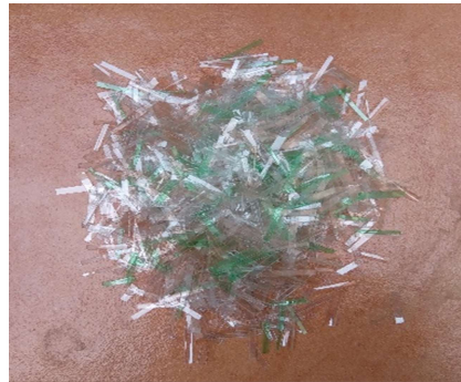
Figura 3. 3. PET, fibras cortas.
