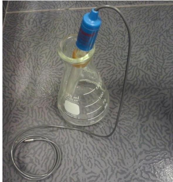
*Fig. 3.1. Electrodo de referencia Calomel.*
