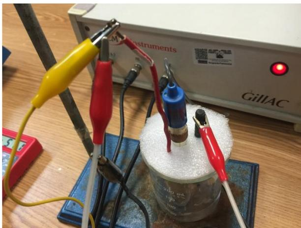
Fig. 4.23. Arreglo de tres electrodos utilizando potenciostato.
