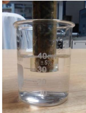
*Fig. 4.15. Probeta de trabajo sumergida en el recubrimiento.*
