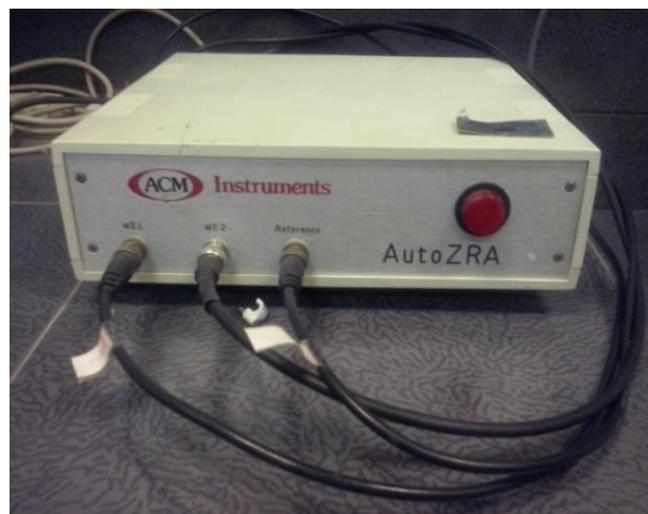
Fig. 4.22. Potenciostato ruido electroquímico.
