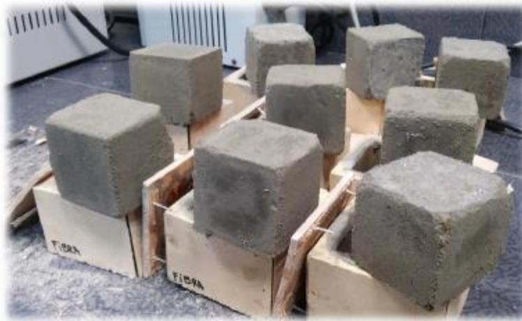
*Fig. 4.6. Especimen desmoldado, clasificado y listo para curado.*
