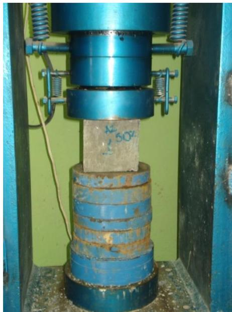
*Fig. 4.26. Prensa hidráulica, resistencia a la compresión.*
