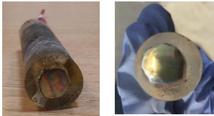
*Fig. 4.16. Tonalidad que se observa en la superficie de la varilla que está expuesta con recubrimiento.*
