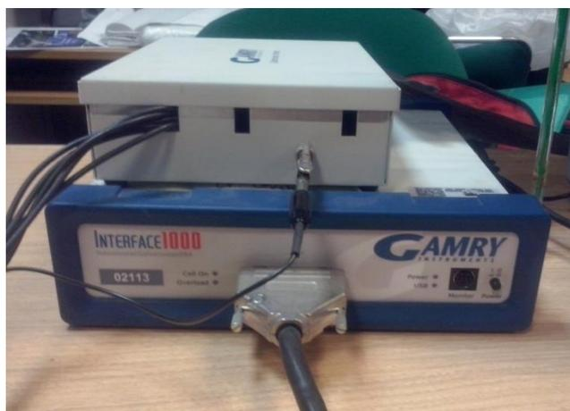
*Fig. 4.20. Potenciostato-galvanostato, resistencia a la polarización lineal.*
