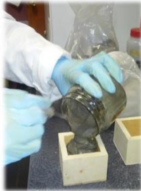
*Fig. 4.4. Vertido del mortero preparado con el material propuesto dentro del molde de madera.*
