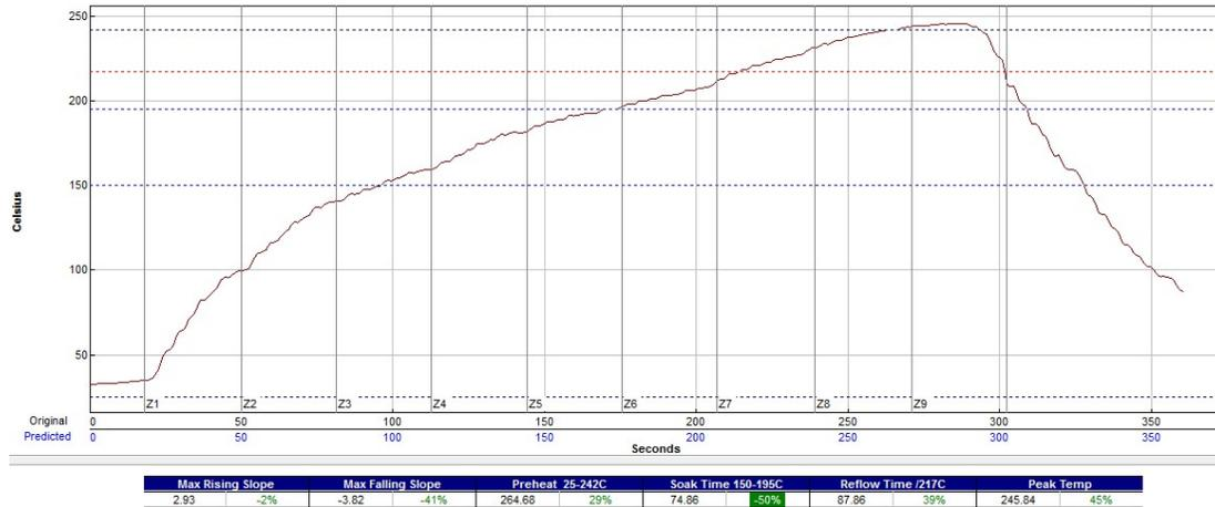
**Figura III.2.8 Temperaturas contra tiempo utilizadas en los PCBs.**
