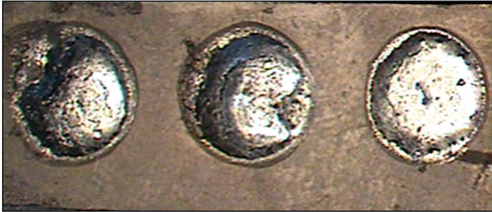
**Figura II.2.2. Wetting, soldadura de estaño sobre níquel.**
