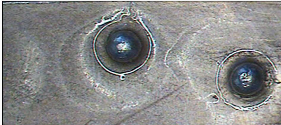
**Figura II.2.3. Solder balling, soldadura de estaño sobre níquel.**
