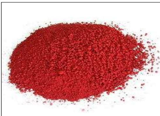
**Figura II.1.11. Óxido de cobre I ( $\text{Cu}_2\text{O}$ ).**
