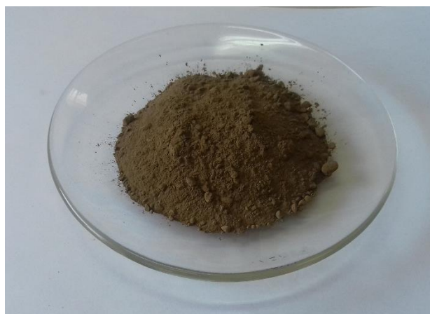
Figura 4.19 Óxidos de tierras raras obtenidos de los magnetos permanentes de discos duros postconsumo.
