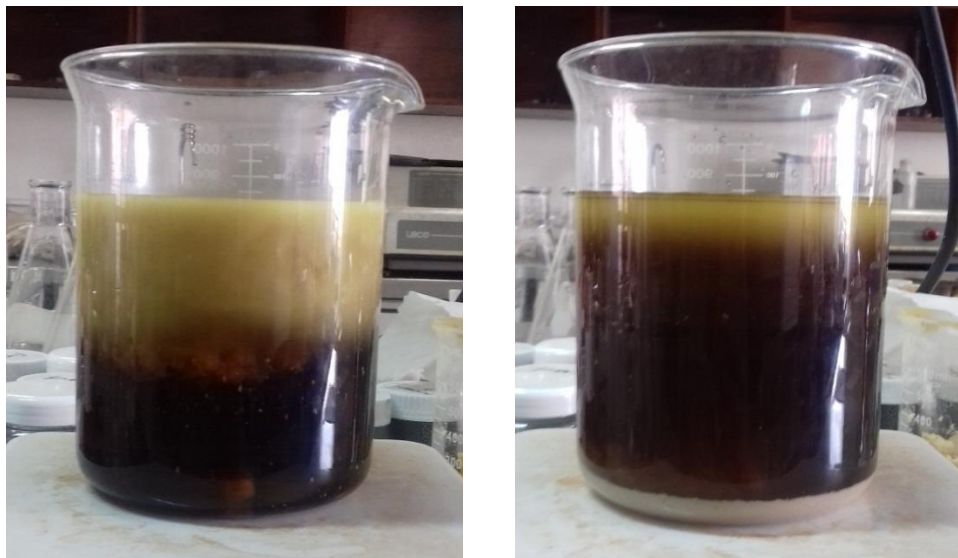
Figura 3.5 Proceso de precipitación de tierras raras contenidas en el licor de magnetos permanentes de discos duros.
