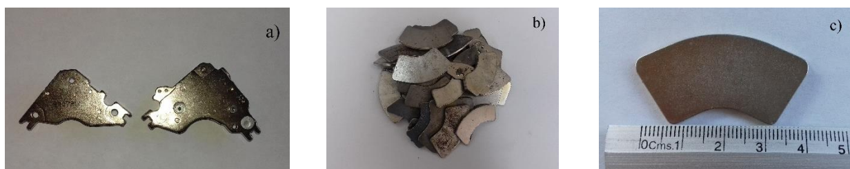
Figura 3.1 a) Magnetos de discos duros, b) Magnetos de discos duros desmagnetizados y desmantelados, c) Material desmagnetizado a 400°C.
