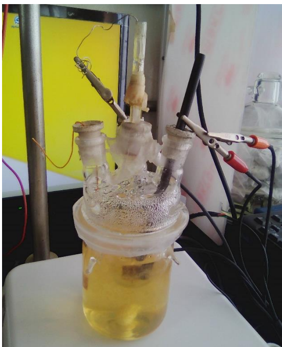
Figura 3.7 Arreglo experimental para las pruebas electroquímicas.
