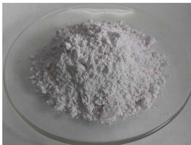
Figura 4.28 Nitratos de tierras raras sintetizados a partir de los óxidos de tierras raras de magnetos permanentes.
