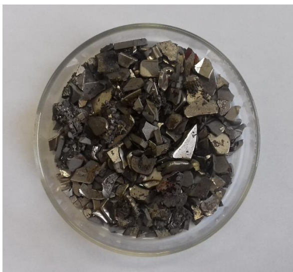
Figura 3.2 Muestra de magnetos permanentes desmagnetizados y reducidos a un tamaño de malla 5 (4 mm).
