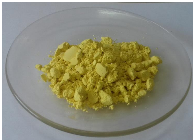
Figura 4.15 Oxalatos de Hierro obtenidos como subproducto del proceso de recuperación de las tierras raras.
