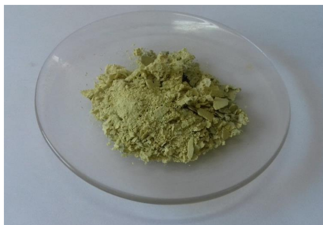
Figura 4.11 Residuos del proceso de purificación de los oxalatos de tierras raras.
