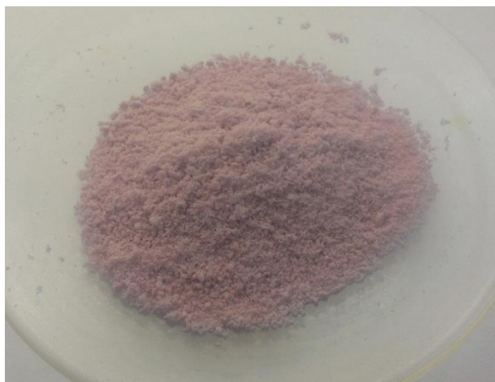
Figura 4.32 Sulfatos de tierras raras sintetizados a partir de los óxidos de tierras raras de imanes permanentes.
