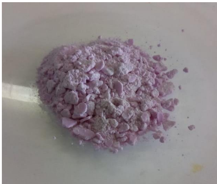
Figura 4.38 Nitrato de neodimio sintetizado a partir de óxidos de tierras raras grado reactivo químico.
