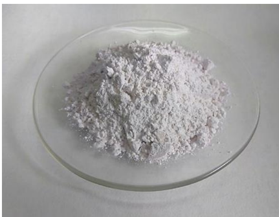
Figura 4.3 Oxalatos de tierras raras (neodimio y praseodimio) sintetizados a partir de los magnetos permanentes de discos duros.
