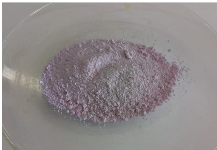
Figura 4.36 Cloruro de neodimio sintetizado a partir de óxidos de tierras raras grado reactivo químico.
