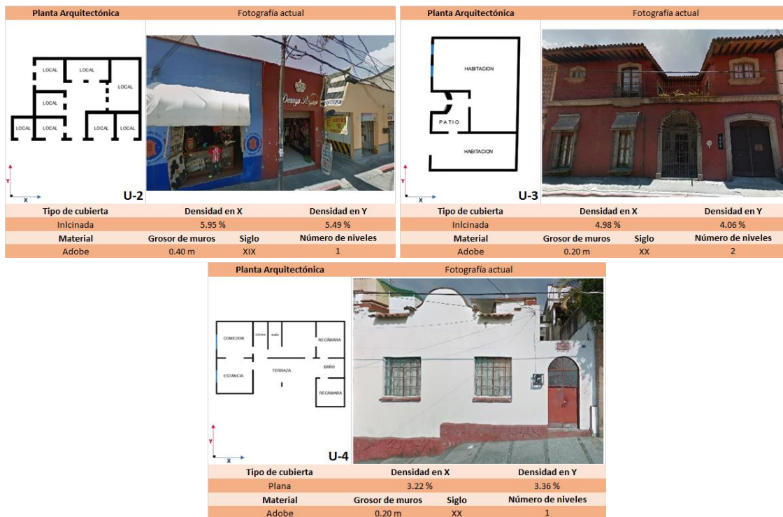
Figura 44. Planta arquitectónica y densidad de muros en los sentidos ortogonales X y Y de las viviendas de planta en “U” con densidad de muros menor al 7% (Elaborada por el autor).
