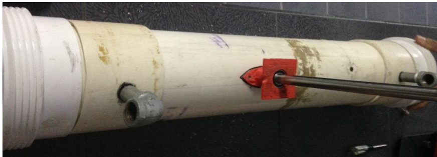
Figura 3.22. Zona de pruebas de la Micro Turbina Hidráulica ilustrando el eje que sale de la transmisión y los puntos donde se medirá la presión.
