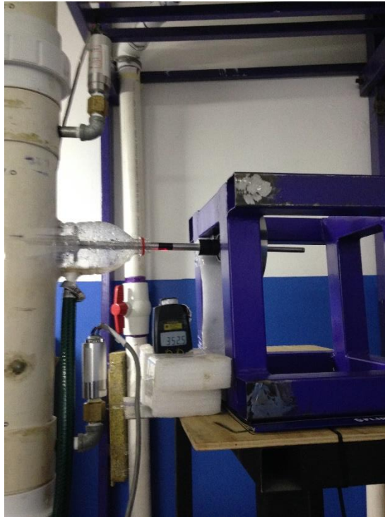
Figura 3.23. Zona de medición de presión y velocidad rotacional así como los instrumentos utilizados.
