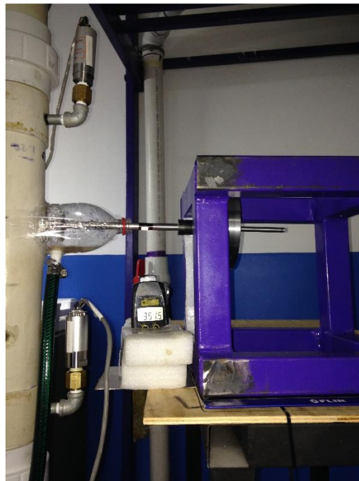
Figura 4.10. Medición de la velocidad angular en una de las pruebas realizadas usando un disco con una masa de 3.5 kg.
