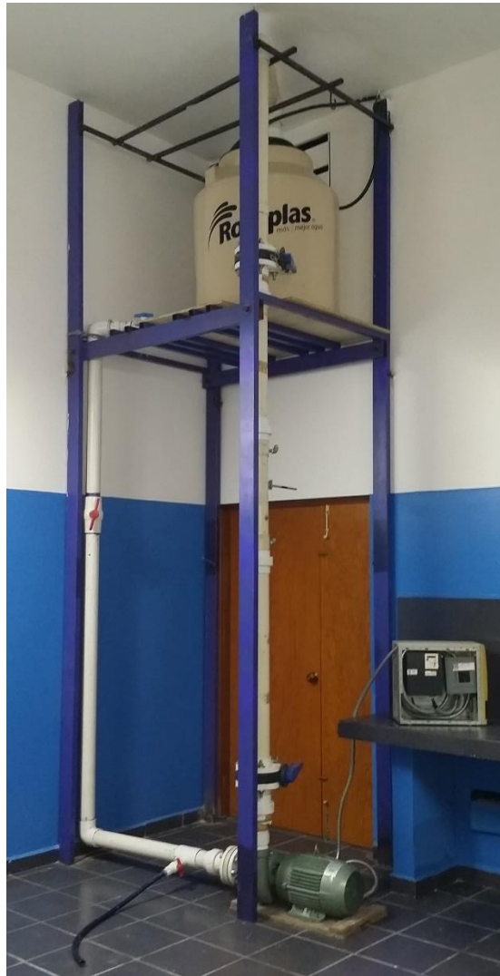
Figura3. 13. Estructura y circuito hidráulico para pruebas experimentales.
