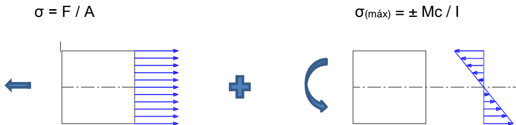
Figura 6 Distribución de esfuerzo interno en un elemento.
