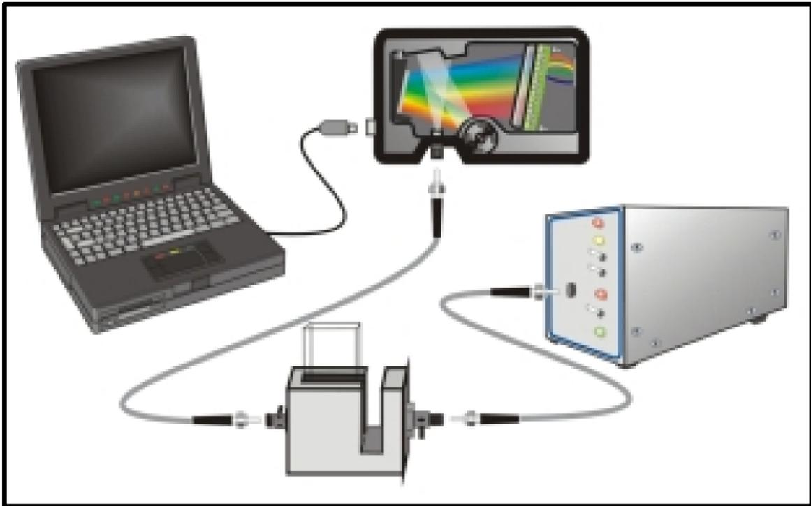
IMAGEN 4.- ARREGLO EXPERIMENTAL DEL EQUIPO A EMPLEAR PARA OBTENER LOS ESPECTROS DE LAS MUESTRAS DE MIEL “CATALASA +”. (Imagen tomada del manual de instalación y operación SpectraSuite, pág. 133, documento número: 000-20000-300-02-2011307).
