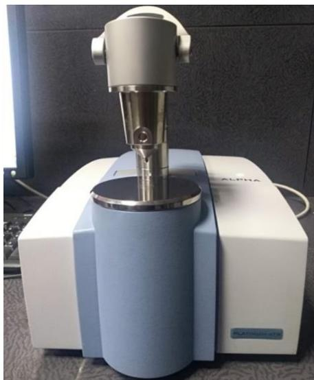
**Figura 8.** Espectrómetro de IR, Bruker ALPHA
